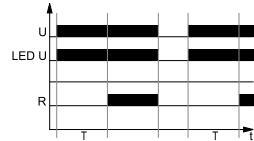
Включение напряжения питания U, начинает отсчет установленного времени  $T$  - задержки включения исполнительного реле R. После отсчета времени  $T$ , исполнительное реле R срабатывает и находится в позиции работы до момента отключения напряжения питания U.
