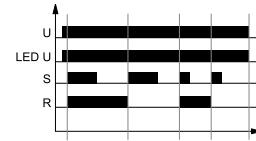
Напряжение питания U должно подаваться на реле времени непрерывно. При включении контакта управления S, сразу срабатывает исполнительное реле R. Каждое последующее включение контакта управления S, приводит к изменению состояния исполнительного реле R на противоположное (свойство бистабильного реле).
