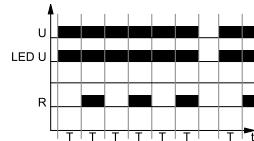
Включение напряжения питания U, инициирует циклическую работу с отсчета времени  $T$  - выключения исполнительного реле R, после которого наступает включение исполнительного реле R на время  $T$ . Циклическая работа длится до момента выключения питания U.
