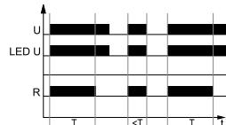
Включение напряжения питания U, сразу срабатывает исполнительное реле R и начинает отсчет установленного времени  $T$ . После отсчета времени  $T$ , исполнительное реле R возвращается в исходное состояние.
