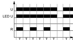
Включение напряжения питания U, инициирует циклическую работу с включением исполнительного реле R на установленное время  $T$ . После отсчета времени  $T$ , исполнительное реле R отключается на время  $T$ . Циклическая работа длится до момента выключения питания U.
